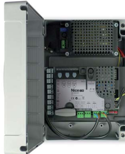
Pod řídicí jednotkou je prostor pro volitelnou záložní baterii
