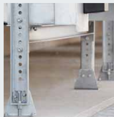
Nastavitelné patky podesty Pomocí výškově nastavitelných podpěr může být úroveň podesty i dodatečně (např. po poklesu budovy) přizpůsobena. Patky podesty jsou v zásadě pozinkovány.
