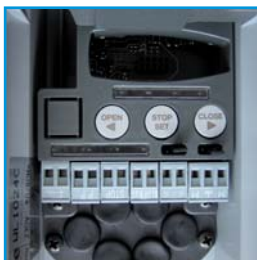
Zabudovaná řídicí jednotka s SM slotem
