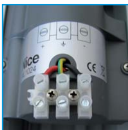
Svorkovnice pro napájení uvnitř druhého pohonu
