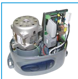
Vestavěná řídicí jednotka v pohonu
