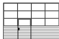
Kombinovaná vrata ocel + hliník s integrovanými personálními dveřmi
